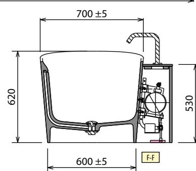
\* Zone pour la préparation du raccordement électrique dans le cas de l'éclairage LED périphérique de la baignoire. Prévoir un interrupteur à distance (non fourni).
