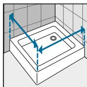
Prendre les mesures (cm) du mur au bord extérieur du receveur de douche. Relever les mesures (cm) après la pose du carrelage. Pour les montages en angle, il faut prévoir que la mesure réelle correspond à la mesure d'encombrement extérieur avec le profilé mural de la paroi en retour. Ceci doit être pris en compte impérativement pour les receveurs carrelés (pose à l'italienne ou receveur sans plage).
