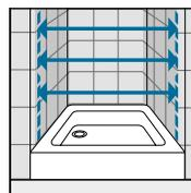
Prendre les mesures (cm) d'un mur à l'autre, en bas, en haut et au milieu et choisir la mesure inférieure. Relever les mesures (cm) après la pose du carrelage.
