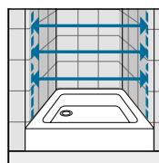
Prendre les mesures (cm) d'un mur à l'autre, en bas, en haut et au milieu et choisir la mesure inférieure. Relever les mesures (cm) après la pose du carrelage.
