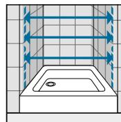
Vermessen Sie den Abstand von Wand zu Wand im unteren, mittleren und oberen Bereich und bentzen Sie den niedrigeren Wert. Die Mae sollen von schon fertig verfliesten Wnden nach den aufgefhrten Skizzen abgenommen werden.
