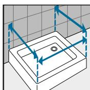
Rilevare le misure da muro a bordo esterno del piatto doccia. Le misure devono essere rilevate sulla parete finita, a rivestimenti posati, secondo gli schemi riportati.
