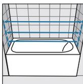
Rilevare le misure da muro a bordo esterno della vasca. Le misure devono essere rilevate sulla parete finita, a rivestimenti posati, secondo gli schemi riportati.
