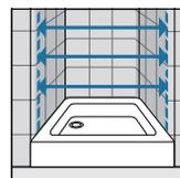
Rilevare le misure da muro a muro, in basso, in alto, al centro e utilizzare quella di valore inferiore. Le misure devono essere rilevate sulla parete finita, a rivestimenti posati, secondo gli schemi riportati.
