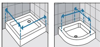
Rilevare le misure da muro a bordo esterno del piatto doccia. Le misure devono essere rilevate sulla parete finita, a rivestimenti posati, secondo gli schemi riportati.
