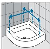
Prendre les mesures (cm) du mur au bord extérieur du receveur de douche. Relever les mesures (cm) après la pose du carrelage. Pour les montages en angle, il faut prévoir que la mesure réelle correspond à la mesure d'encombrement extérieur avec le profilé mural de la paroi en retour. Ceci doit être pris en compte impérativement pour les receveurs carrelés (pose à l'italienne ou receveur sans page).
