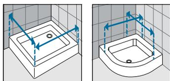
Prendre les mesures (cm) du mur au bord extérieur du receveur de douche. Relever les mesures (cm) après la pose du carrelage. Pour les montages en angle, il faut prévoir que la mesure réelle correspond à la mesure d'encombrement extérieur avec le profilé mural de la paroi en retour. Ceci doit être pris en compte impérativement pour les receveurs carrelés (pose à l'italienne ou receveur sans plage).
