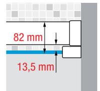
Détail du système de fixation au receveur de douche.
