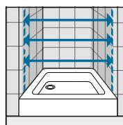
Vermessen Sie den Abstand von Wand zu Wand im unteren, mittleren und oberen Bereich und benützen Sie den niedrigeren Wert. Die Maße sollen von schon fertig verfliesen Wänden nach den aufgeführten Skizzen abgenommen werden.
