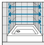
Vermessen Sie den Abstand von Wand zu Wand im unteren, mittleren und oberen Bereich und benutzen Sie den niedrigeren Wert. Die Maße sollen von schon fertig verfliesten Wänden nach den aufgeführten Skizzen abgenommen werden.
